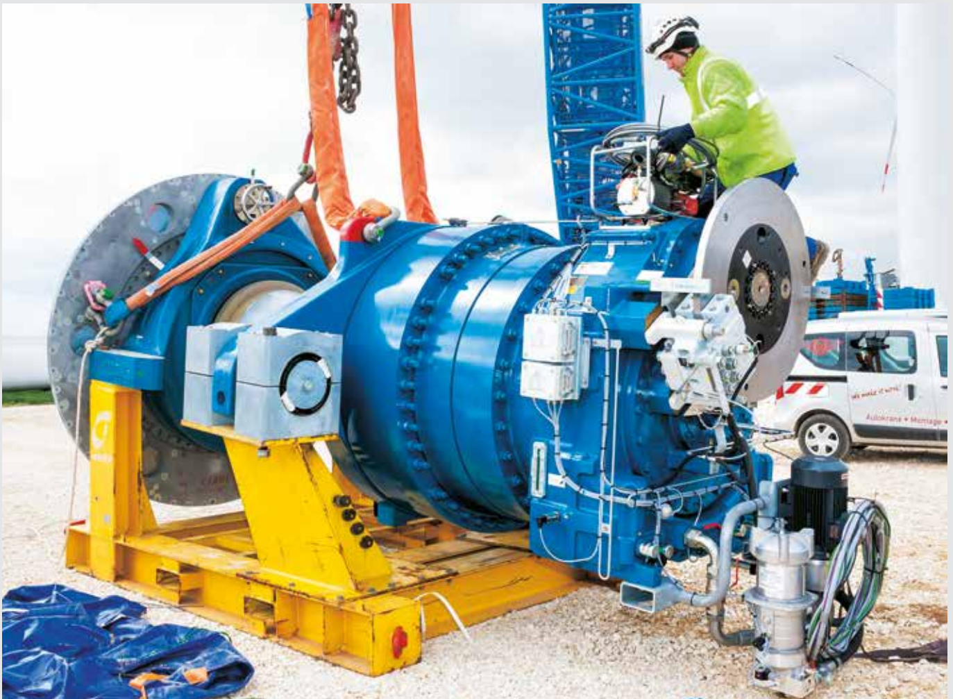
Getriebe (Generatorseite) mit Scheibenbremse
